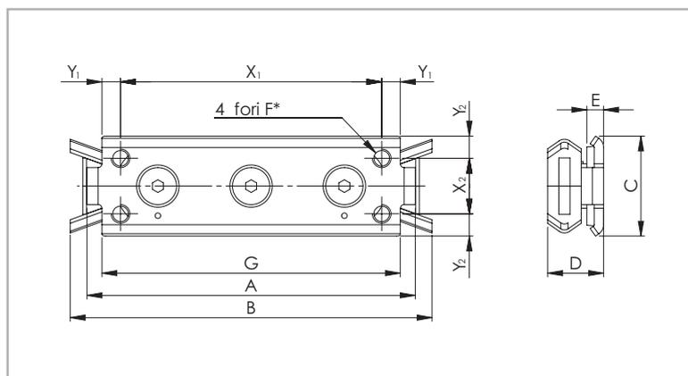
\* Per la sezione 20 : 2 fori M5 sull'asse centrale a distanza  $X_1$
